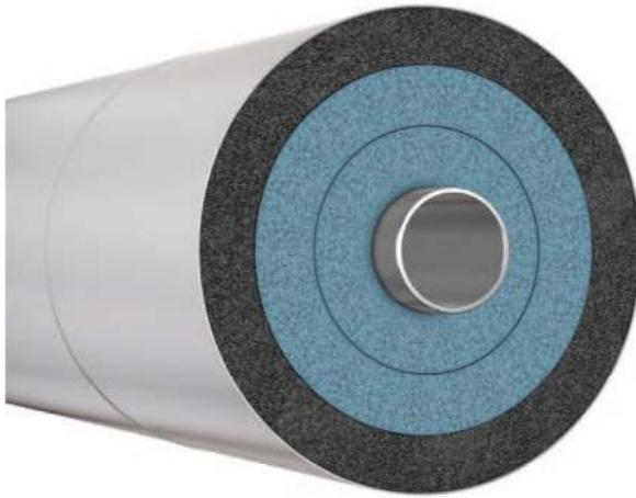
为满足深冷低温管线对保冷系统的独特要求，Armaflex 低温系统可以通过结合一些辅助手段来达到最低至 -200°C 的保冷绝热目的。例如针对深冷且反复移动的管线，可以通过在 Armaflex LTD 材料内表面复合耐磨层薄膜的方式来进行保冷绝热。这一耐磨层的敷设可以提高材料表面强度从而保护安装在经常振动和移动的管路上的绝热系统。
