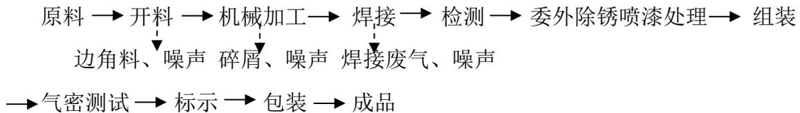
图1 本项目生产工艺流程和产污环节
